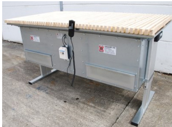
Pussebord med innebygd avsug og eksplosjonssikker motor.
